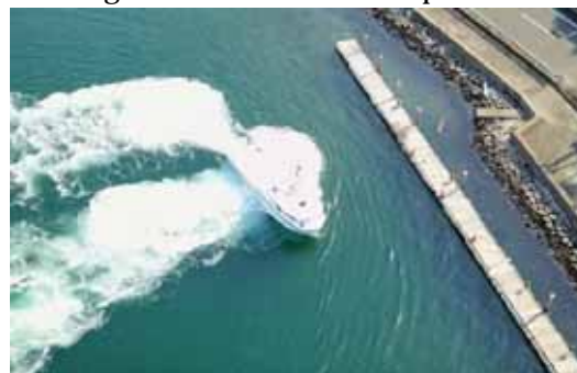
図4 遠隔操船による着岸実験 Fig.4 Berthing experiment by remote control
