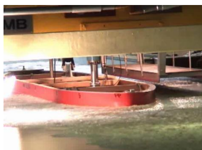
図 1 当社の氷海水槽における BIC 試験の様子 Fig.1 Brash ice channel test in the Japan Marine United Ice Model Basin
