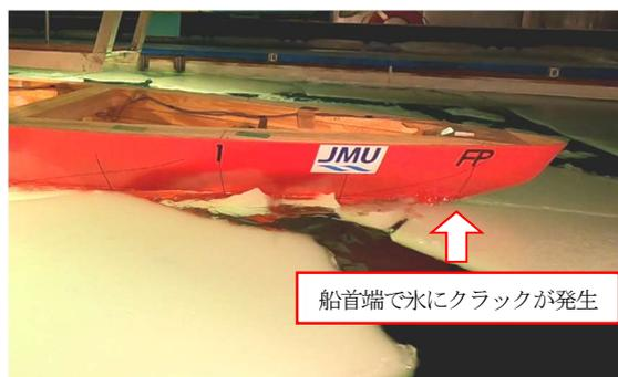
図 2 流氷の破壊
