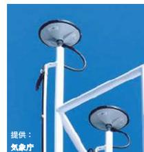
大気中の水蒸気量の影響で、GPSなどの測位衛星からの電波到達がわずかに遅れることを利用して、船の上空の水蒸気量を観測するための装置である。
