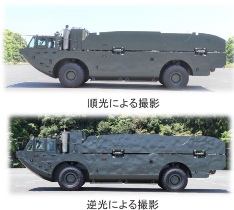
図1 撮影条件による歪み比較
