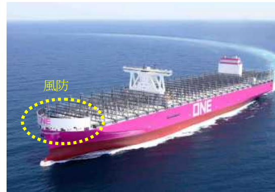
図1 24,000TEU コンテナ船に装備された風防 1) Fig.1 Bow wind cover on 24,000TEU container
