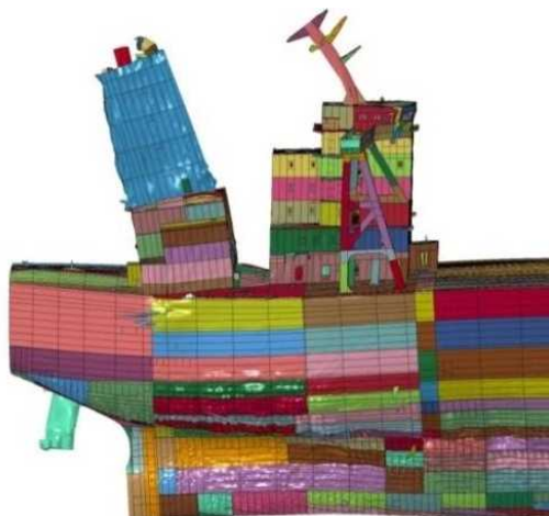
図10 5000万自由度モデルにおける8.3Hzでの振動モード
