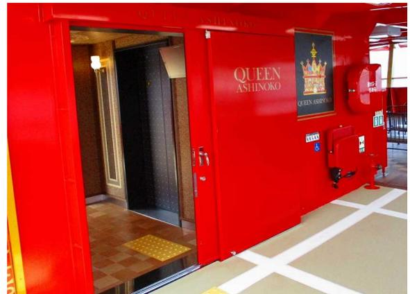
図1 バリアフリー設備（車椅子置き場、段差のない引戸、点状ブロック、エレベータ）
